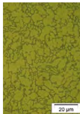
Zwei Schmiedestrukturen in einem Bauteil (Hals): globulares Gefüge (links); gestrecktes Gefüge (rechts). Links V=400:1, rechts: V=1000:1
