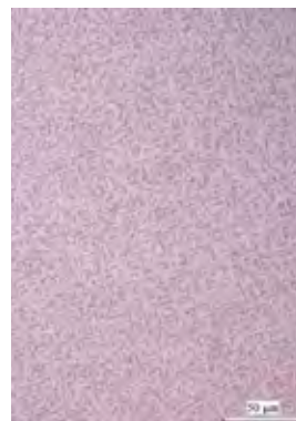
Über den gesamten Querschnitt isotropes Mikrogefüge eines Feingussteils, das bei VACUCAST® thermochemisch nachbehandelt wurde. Links: V=400:1, rechts: V=1000:1
