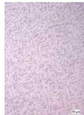
Über den gesamten Querschnitt isotropes Mikrogefüge eines Feingussteils, das bei VACUCAST® thermochemisch nachbehandelt wurde. Links: V=400:1, rechts: V=1000:1
