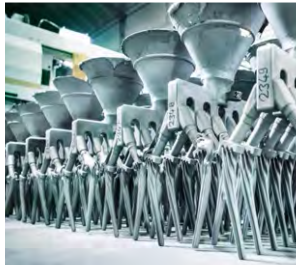
Gegossene Endoprothesen-Rohlinge für Hüftendoprothesenschäfte bei VACUCAST®
